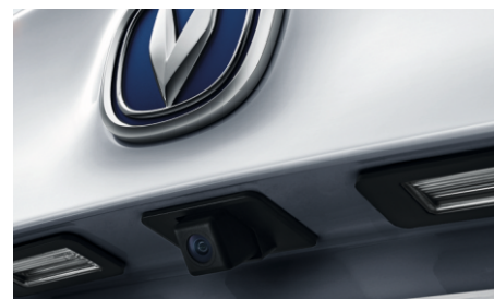
Камера заднего вида с динамической разметкой
